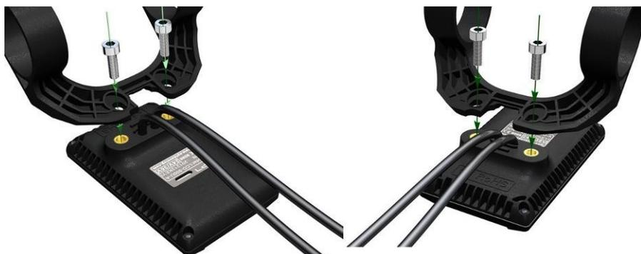
I morsetti sono adatti per tre formati di manubrio: 31.8mm, 25.4mm e 22.2mm, mediante anelli adattatori in plastica forniti nella confezione. Gli anelli devono essere montati come indicato nell'immagine seguente.
