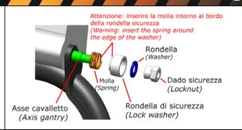
6) Posizionare il veicolo a terra, sostenuto dal suo cavalletto, inserire l'antifurto e se necessario aiutarsi manualmente nel centrare l'innesto del perno nel foro piastra mobile.
