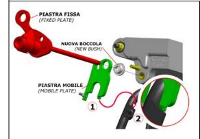
3) Assemblare l'antifurto rispettando l'ordine dei pezzi come da foto. Accostare e allineare la piastra mobile nel cavalletto come da punto (1) e (2). Montare la piastra fissa inserendo l'asse nel carter e nel cavaletto.
