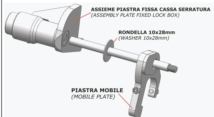
**4)** inserire, così come composto, l'assieme nel cavalletto attraversando i fori di sostegno nel carter, verificando che la piastra fissa coincida con il bordo carter motore (1) e la piastra mobile blocchi il cavalletto (2)
