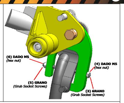
8) Rimontare la molla di ritorno del cavalletto precedentemente smontata e verificare inserendo e disinserendo varie volte che il sistema funzioni correttamente. A questo punto serrare il dado di sicurezza avvitato precedentemente fino a spezzarne la testa.
