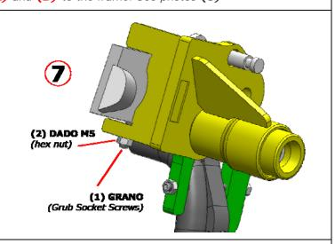
6) Bloccare la PIASTRA FISSA così montata con il nuovo PERNO di SICUREZZA senza STRINGERE FORTE e ASSOLUTAMENTE SENZA SPEZZARNE LA TESTA. Foto (6) Successivamente serrare il grano (1) bloccandolo con il controdado (2). Foto (7)
