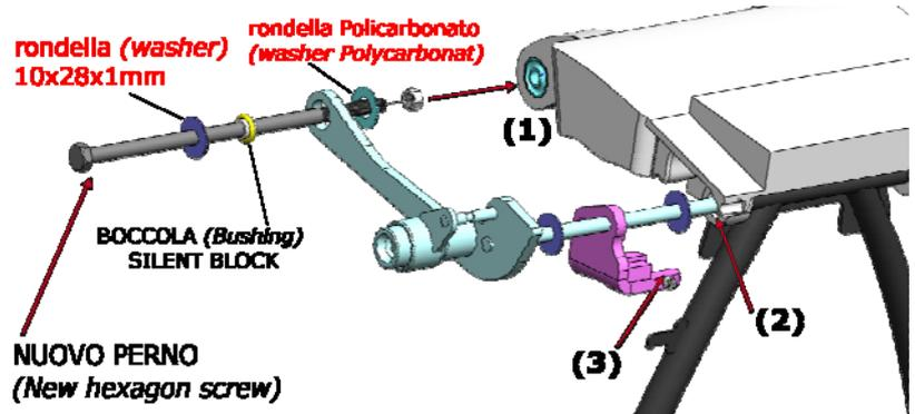
6) Serrare prima l'asse con il dado di sicurezza **senza spezzarne la testa**, rispettando l'ordine dei pezzi, vedi foto (**ATTENZIONE ASSOLUTAMENTE NON SPEZZARE TESTA DADO e USARE LOCTITE SULLA FILETTATURA DELL'ASSE**)
