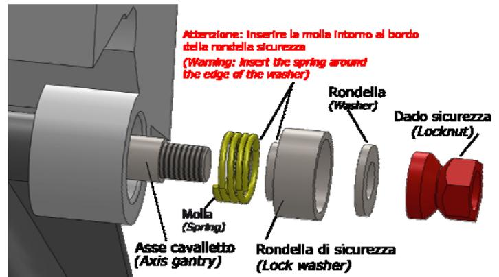
7) Serrare FORTE IL PERNO SUPPORTO MOTORE con il NUOVO BULLONE, rispettando l'ordine dei pezzi, vedi foto (**ATTENZIONE USARE LOCTITE SULLA FILETTATURA DEL PERNO**)
