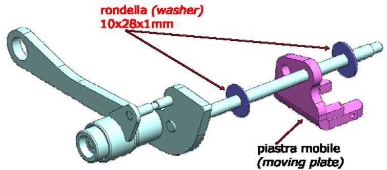
5) inserire, così come composto, l'assieme nel cavalletto attraversando i fori di sostegno nel carter (2) reinserire il **NUOVO PERNO** nel supporto motore (1) verificare che la piastra mobile blocchi il cavalletto (3)
