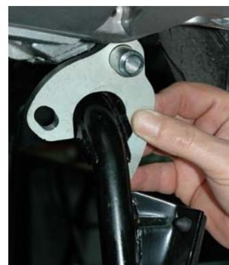
**6.** Sganciare la molla lunga (proveniente dal telaio) dall'asse anteriore del motore. Svitare il dado dal lato destro dell'asse anteriore di sostegno del motore. Estrarre l'asse ed inserirlo al contrario di come è installato originariamente, vale a dire **la testa dell'asse si deve inserire dal lato destro del veicolo.**
