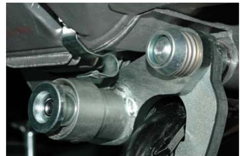
**15.** A questo punto serrare sull'asse anteriore del motore il dado di sicurezza con foro passante, precedentemente avvitato al punto 9. **e spezzarne la testa.** Riagganciare la molla lunga alla gola ricavata nel dado di sicurezza con foro passante.
