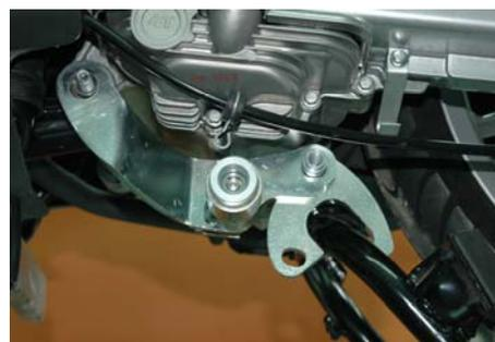
**8.** Avvitare il dado di sicurezza con la relativa rondella Ø30 mm l'albero motore anteriore, analogamente a quanto fatto a punto 3, assicurandosi che la rondella sia rivolta correttamente Stringere ancora senza rompere il dado di sicurezza (vedi foto)
