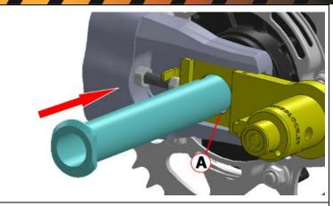
6) Stringere forte l'asse ruota. Avvitare con la vite Esagonale M5x16 (B) il blocco sicurezza dell'asse (A)
