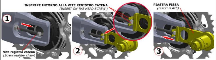
4) Svitare la vite del registro catena. **figura (1)** Inserire il gancio presente sulla piastra fissa intorno al corpo e alla testa della vite. **figura (2)** Riavvitare la vite del registro della catena inserendo la piastra fissa nella sede del forcellone. **figura (3)**
