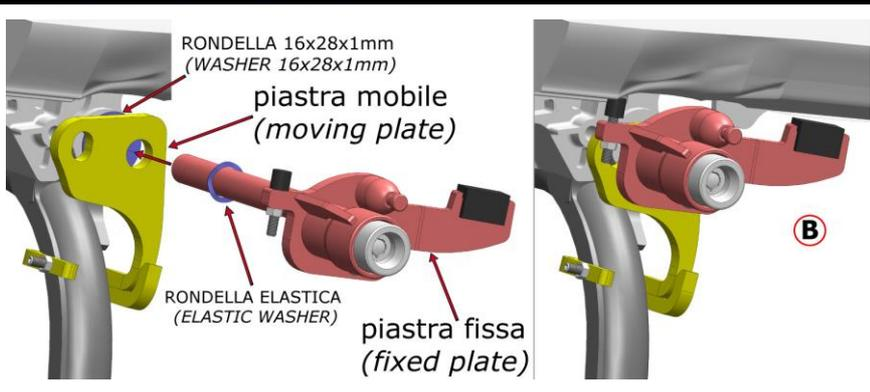
4) Assemblare l'antifurto inserendo la RONDELLA ELASTICA all'asse **(A)**, infilare fino in fondo l'asse attraverso la PIASTRA MOBILE e la RONDELLA 16X28X1 precedentemente posizionata, rispettando l'ordine dei componenti come da foto fino in posizione **(B)**
