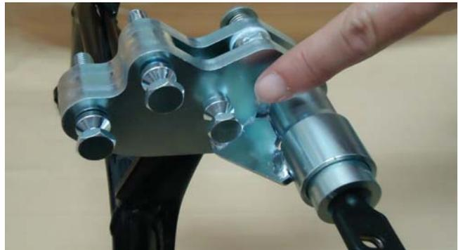
9. Posizionarlo sotto al veicolo e avvitare in modo alternato i due perni di sicurezza lunghi nel carter motore. Vedi foto.
