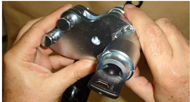
8. A questo punto avvitare il perno di sicurezza corto in dotazione nel foro centrale, **senza stringere**. Inserire l'intero corpo così assemblato sul cavalletto dal lato sinistro. Vedi Foto
