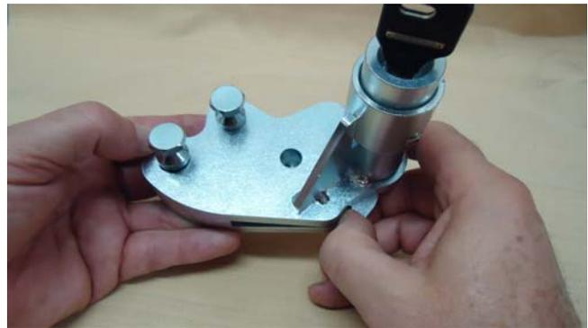
6. Rimuovere dal cavalletto la boccola originale dal lato sinistro e sostituirla con la boccola in dotazione nel kit. (diversa di spessore). Vedi foto
